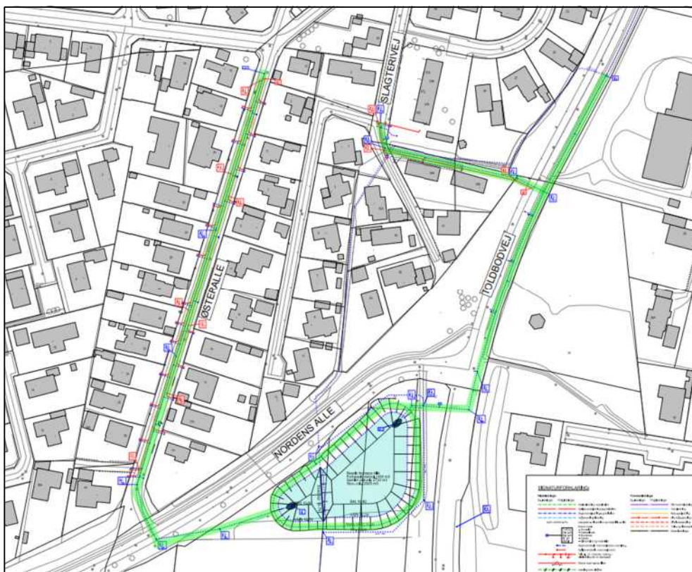
Kort over strækningen hvor der skal grundvandssænkes (vist med grøn).
