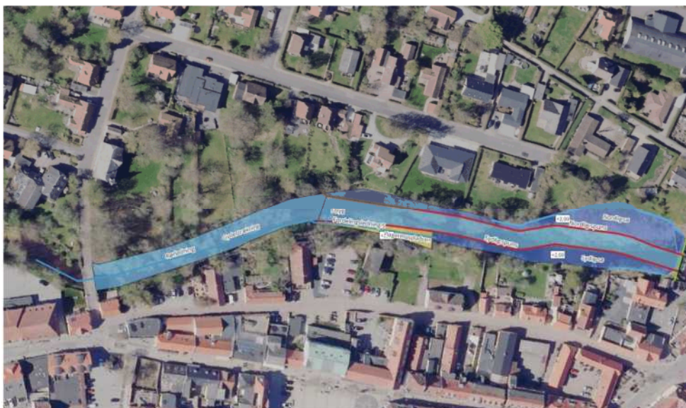
Figur 1 – Konceptskitse for projektet. Rød angiver spunsvægge, gul angiver udvidelsen af Flagermuspladsen.
