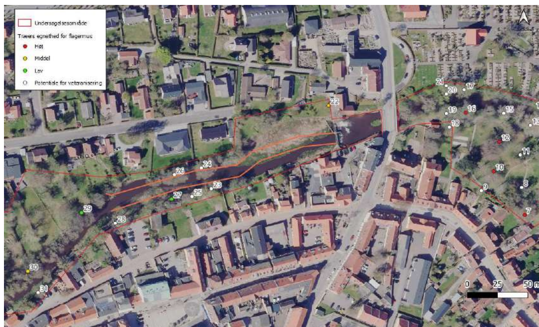
Figur 5. Konceptskitse for projektet. Rød-orange streg angiver spunsvægge. Træernes egnethed for flagermus markeret.
